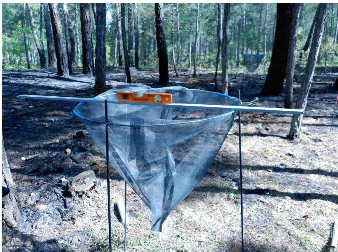
Figura 2. Instalación de colector de desfronde. Autor: Grupo de Incendios Forestales ICIFOR-INIA (CSIC) 2016
