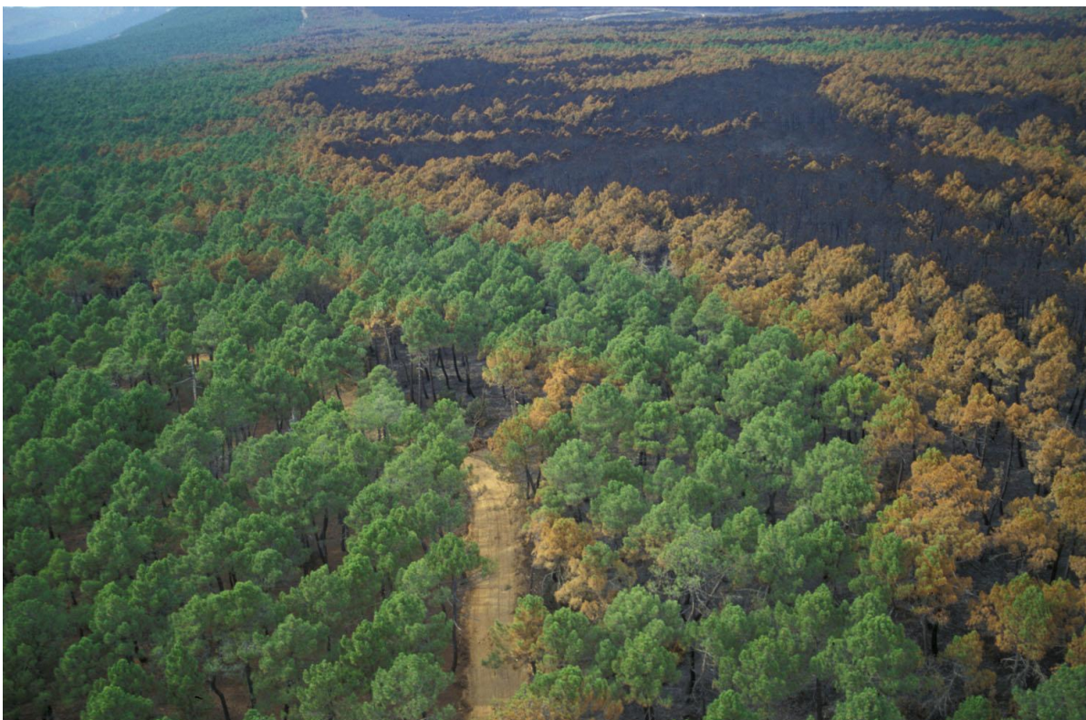
Figura 8. La imagen sirve para ejemplificar cómo se desarrolló la extinción en las zonas menos comprometidas: se abrió una pasada de buldócer a una distancia de unos 100 m del frente y a medida que la máquina avanzaba detrás se iba quemando. El efecto de succión provocaba una rápida progresión del fuego aplicado, pero sin llegar a quemar las copas de los pinos. Donde se encontraban frente y contrafuego se generaban grandes llamas, como colofón de la actuación. Este comportamiento del
